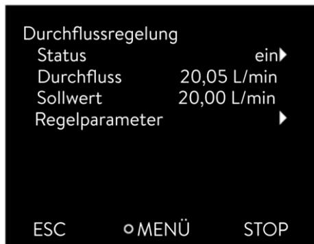
1. Wählen Sie die Menüeinträge ⇒ Module ⇒ Durchflussregelung ⇒ Regelparameter aus.
